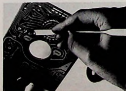
Der Klebstoff wird mit einer kleinen Schaufel aufgebracht
